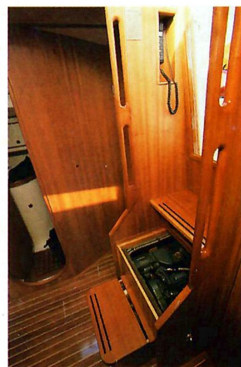
Handgrepen aan beide zijden van de kajuittrap. De motor kan zowel aan de voorkant als aan de achterzijde goed bereikt worden.
