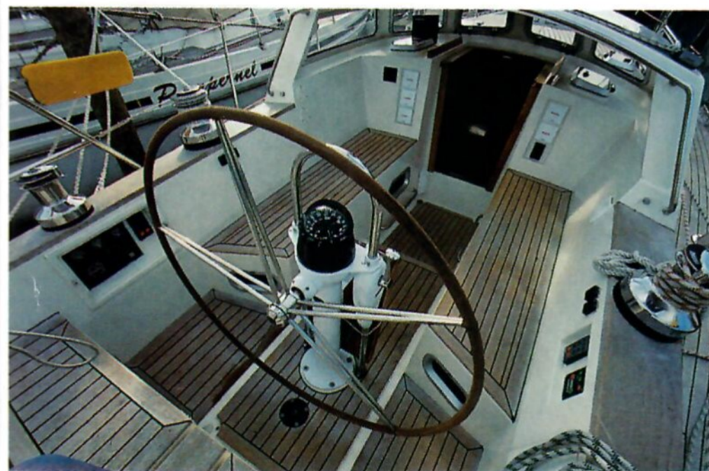
De mooi gevormde vaste buiskap is voorzien van een stevige grijpbeugel. De grootschootoverloop is op de buiskap geplaatst, zodat de kuip vrij gehouden wordt.
