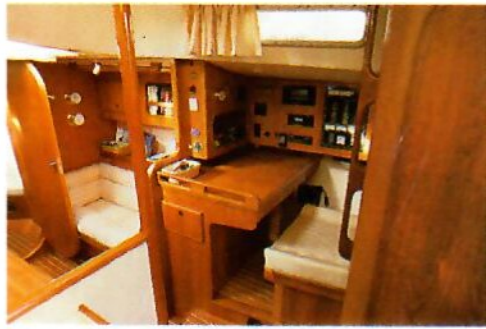
Een zeewaardige navigatiehoek: voorgevormde zit, volop handgrepen en ruime mogelijkheden om apparatuur in te bouwen.
