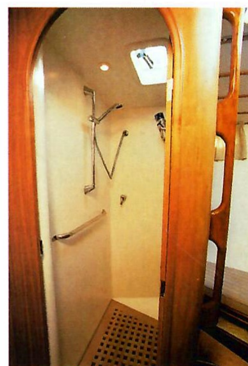
Geen voor vocht gevoelige houten delen in de natte cellen. Er kan goed geventileerd worden. Fraai detail: zelfs in de douche is een handgreep.
