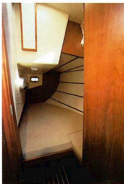
De tweepersoons wacht- of gastenhut aan bakboord naast en onder de kuip kan met de patrijspoort goed geventileerd worden.
