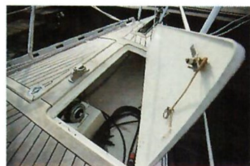
De ondiepe ankerbak is via een dubbelluik te bereiken en biedt naast de ankerlier plaats voor touwwerk.
