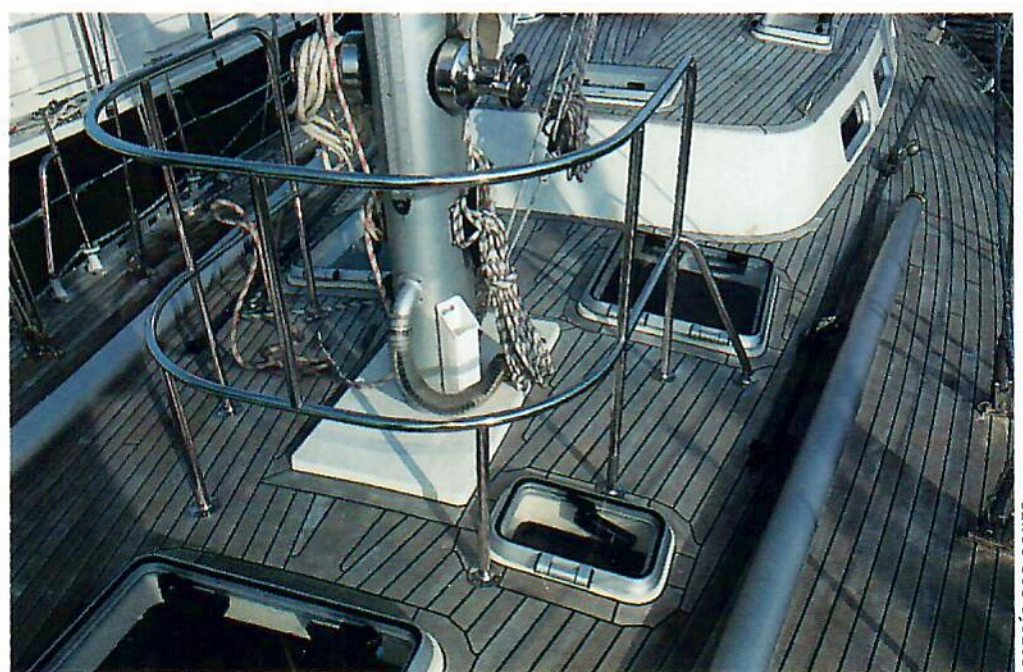
De bediening van vallen en smeerrepen is geheel volgens de 'Koopmans-doctrine' bij de mast. Een heupsteun maakt het werken op deze plaats veilig.
