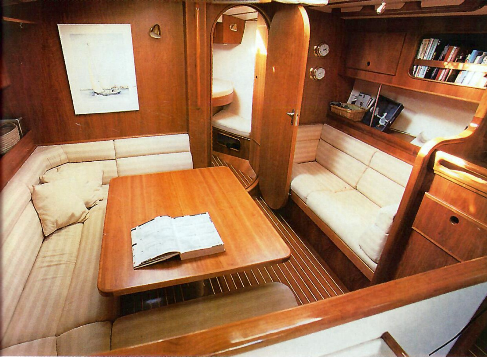
Gerieflijk voorgevormde kajuitkussens verbergen de tanks onder de banken. De accu's zijn eveneens centraal geplaatst, op de kiel. Zo zijn de meeste zware onderdelen op en rond de kiel gegroepeerd, zoals het op een zeegaand jacht betaamt.
