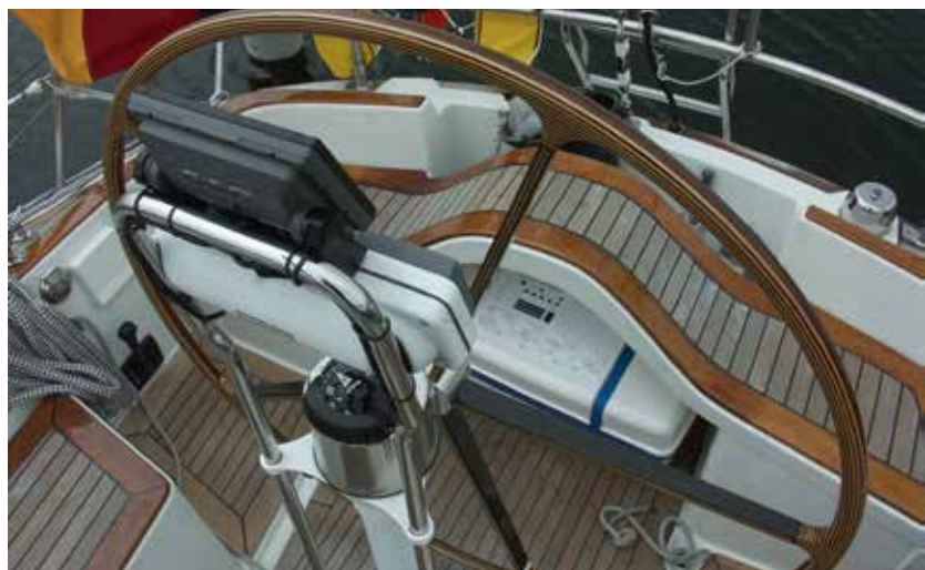
Nur vom Feinsten - das Steuerrad aus lamelliertem Holz mit Carbonverstärkung ist eine teure, aber wunderschöne Sonderanfertigung. Der erhöhte Steuermannssitz sorgt für gute Sicht voraus.
