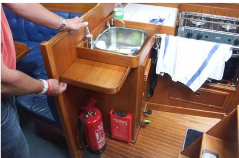
Ein weiteres Detail, das von guter Planung unter Deck zeugt, ist dieses kleine Klapp Tischchen, mit dem sich die Stellfläche in der Pantry bei Bedarf vergrößern lässt.
