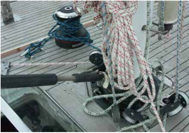
Hydraulik und Umlenklöcke sind original, die Selftailing-winschen nachgerüstet. Bereits ab werft wurde an der Decksausstattung nicht gespart.
