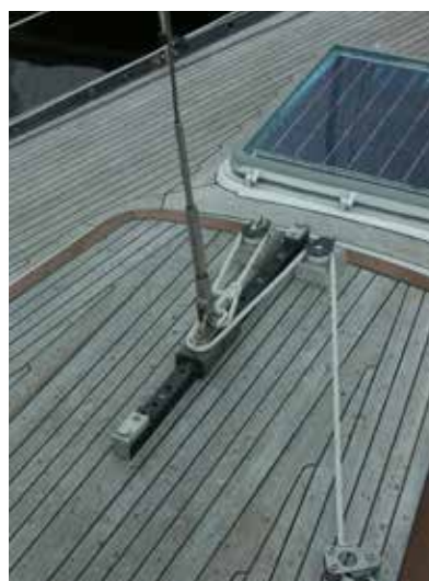
Über eine Schiene wird das Babystag auf Spannung gebracht, die Trimmleine kann von achtern bedient werden.
