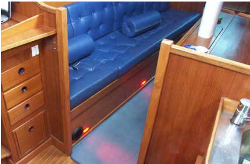
Ein weiteres schönes Detail sind die roten Nachlichter über dem Boden. Der Durchgang zum Salon ist unnötig eng ausgefallen, weiterhin stören die scharfen Ecken der Abschlussprofile das Bild.
