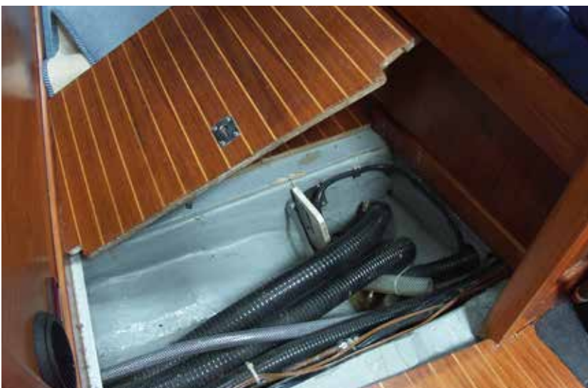
Auch unter den Bodenbrettern findet sich eine solide Struktur, die Laminatarbeiten sind dauber ausgeführt und mit Topcoat versiegelt.
