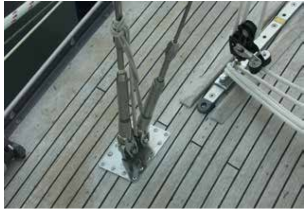
Die Püttinge laufen unter Deck auf solide Längsträger, die Konstruktion verträgt hohe Riggspannungen. Teakkeile neben den Genuaschienen schützen die Füße.
