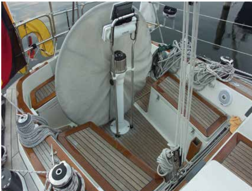
Das recht kurze T-Cockpit bietet viel Schutz und Komfort bei Lage, auch auf dem Süll kann man gut sitzen. Unter der Ruderbank ist Platz für die Rettungsinsel, weiterhin findet sich dort das Gasflaschenfach.
